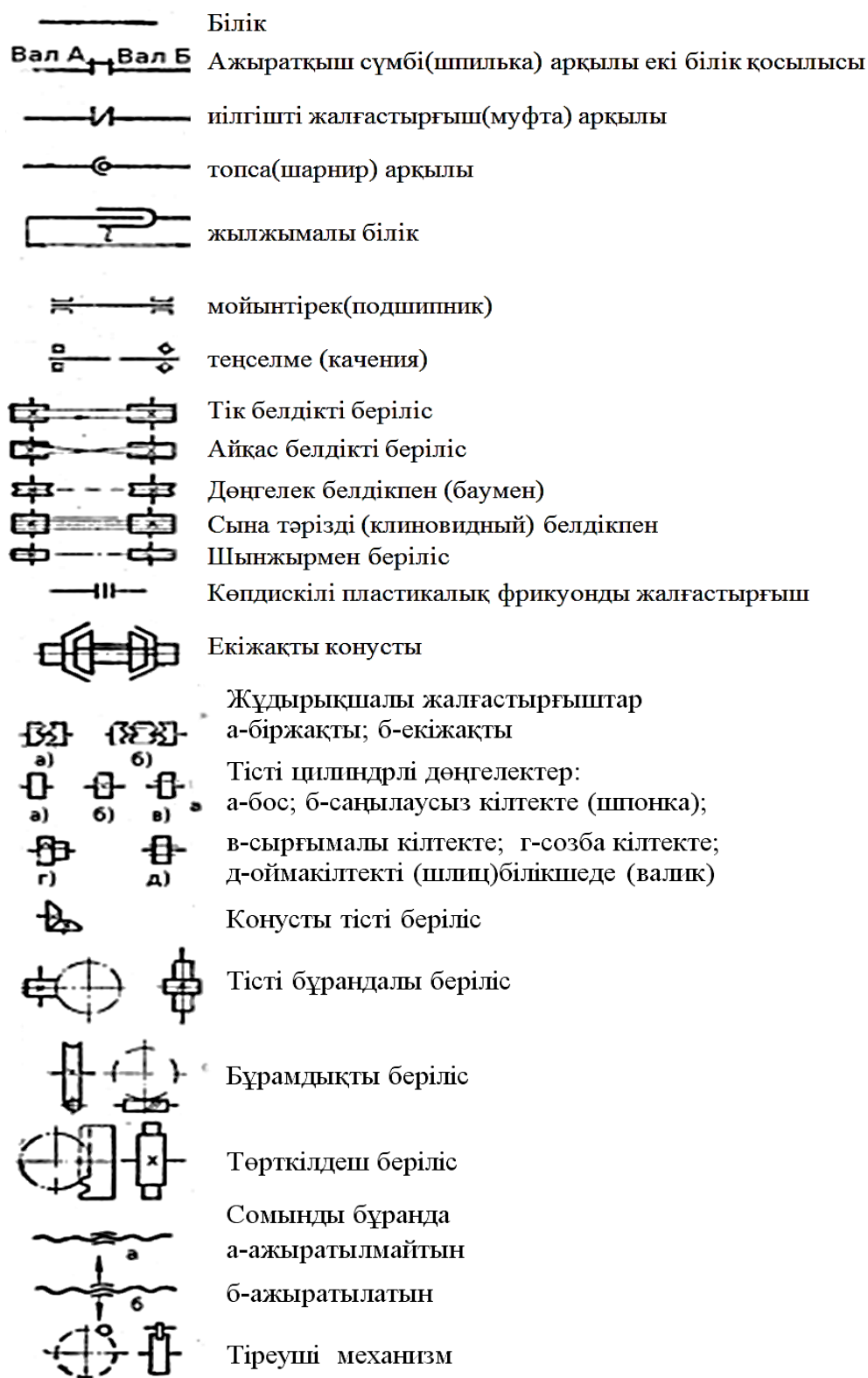
Сурет 3.1. Біліктердің кинематикалық сұлбаларындағы негізгі шартты белгілер. [9]
