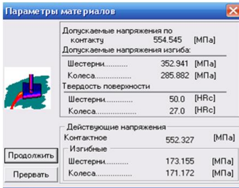
Сурет 4.2. Рұқсат етілетін және жұмыс кернеулері
